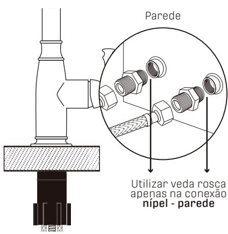
**5- Encaixe a ducha na torneira e o contrapeso na volta da mangueira extensível, conforme imagem abaixo.**
