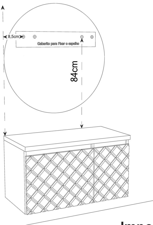
Para a fixação do espelho colocar o gabarito na horizontal e depois fazer a furação dos suportes
