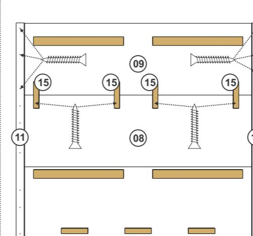
Fixar as peças 15 na peça 08 com Parafuso 3,5x25. Fixar a peça 09 nas peças 11 com Parafuso 3,5x25.
