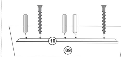
Fixar a peça 10 na peça 09 com Parafuso 5x50 e Cavilha.
