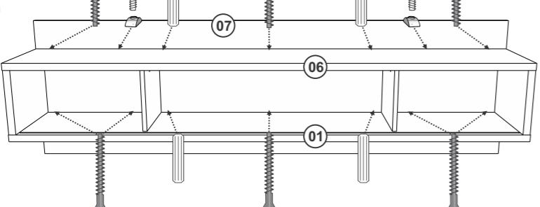
Fixar a peça 07 nas peças 01 e 06 com Parafuso 5x50, Cavilha e Parafuso com porca Elíptica.
