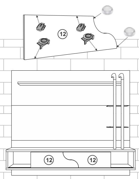
Fixar os Sistemas deslizantes nas Portas 12 com Parafuso 3,5x20. Fixar os silicones nas portas conforme ilustração a cima. Encaixar as portas no Trilho.
