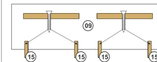
Fixar os apoios 15 na peça 09 com Parafuso 3,5x25.
