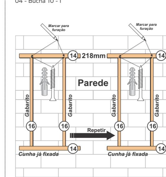
Encostar os 2 gabaritos 16 na cunha 14 já fixada na parede, colocar a outra cunha encostada na parte superior do gabarito e marcar a parede para colocar a bucha e fixar a cunha com Parafuso 6x80. Repetir para a cunha fixada do lado direito.
