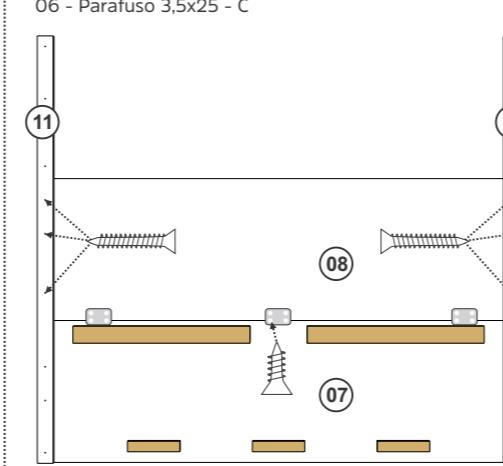
Fixar a peça 08 na peça 07 com Chapinha de ferro e Parafuso 3,5x12 e nas peças 11 com Parafuso 3,5x25.
