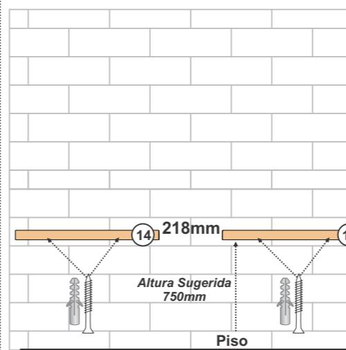
Fixar as cunhas de fixação 14 na parede com Parafuso 6x80 e Bucha 10. Deixar uma distância de 218mm entre as cunhas.
