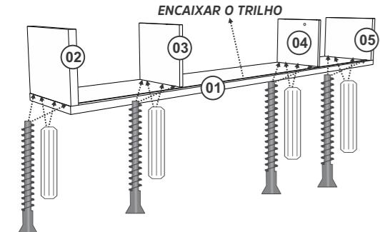
Encaixar o Trilho na peça 01. Fixar as peças 02, 03, 04 e 05 na peça 01 com Cavilha e Parafuso 5x50.
