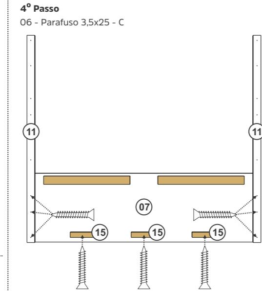
Fixar as peças 11 e 15 na peça 07 com Parafuso 3,5x25.
