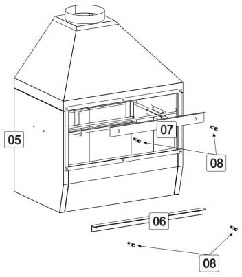
Passo 1: Utilize a cantoneira como gabarito, para marcar a posição dos furos e determinar a altura desejada. Fixe a cantoneira, utilizando os parafusos do kit.
