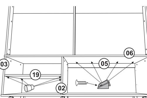
Fixar a peça 05 na peça 06 com Suporte angular e Parafuso 3,5x12 flangeado e com Cantoneira Metálica e Parafuso 3,5x12. Fixar os suportes da prateleira removível 19 nas peças 02 e 03.
