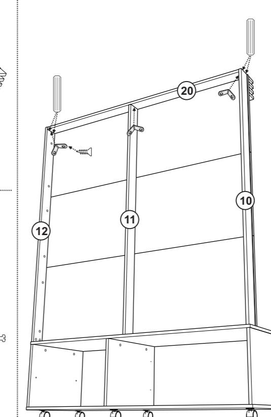
Fixar a peça 20 nas peças 10 e 12 com Cavilha e Cantoneira metálica e na peça 11 com Cantoneira metálica.
