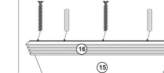
Fixar as peças 16 na peça 15 com Parafuso 5x50 e Cavilha.
