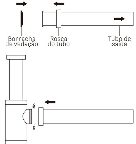
**4-** Passe o acabamento pelo tubo de saída e o encaixe no ponto de esgoto. Caso a saída seja padrão DN40, utilize o adaptador para vedar a saída.
