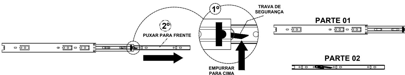
8º - Parafuse a **parte 01 das corredeiras** na lateral esquerda e na divisão, seguindo as marcações, utilizando **03 parafusos** 3,5x12 Ch. Ph.
