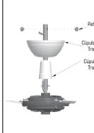
Insira a haste na cúpula inferior tradicional e a cúpula superior encontrando ambas aproximadamente no centro da haste, como mostrado na figura. Passe os cabos elétricos pelo orifício inferior da haste, saindo pelo orifício superior. Desça a cúpula inferior tradicional de modo que a mesma esconda a cúpula.
