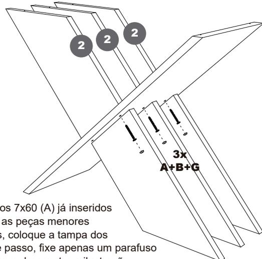
Utilizando os parafusos 7x60 (A) já inseridos nas arruelas (B), fixe as peças menores sem furos (2). Depois, coloque a tampa dos parafusos (G). Nesse passo, fixe apenas um parafuso em cada peça, conforme demonstra a ilustração.
