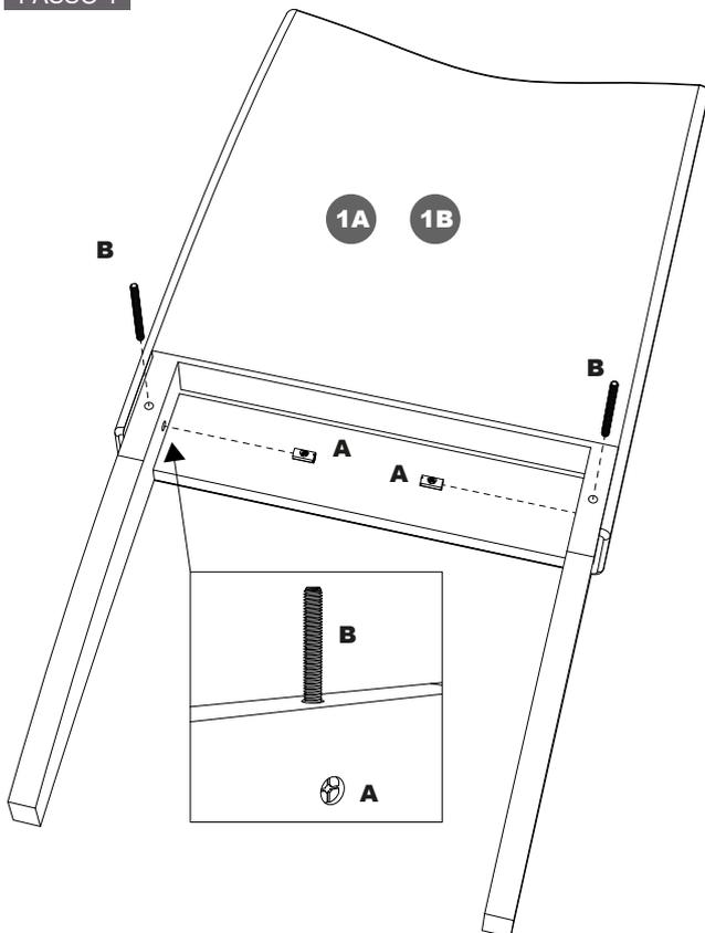
Coloque as porcas cilíndricas (A) nos locais indicados, depois coloque as barras roscadas (B) nas porcas cilíndricas (A) girando-a com as mãos. É necessário que a barra dê pelo menos 5 voltas completas para garantir a fixação da cadeira.
