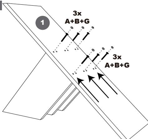
Fixe a peça maior (1) no conjunto montado anteriormente utilizando os parafusos 7x60 (A) com as arruelas (B) já inseridas. Depois, aplique as tampas (G) nos parafusos.
