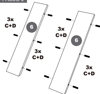
Coloque cola (D) nos furos do detalhe da mesa (6) e encaixe as cavilhas (C) com o auxílio de um martelo.
