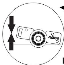
**DICA:** Devido ao desnível do piso, a porta pode apresentar diferença ao encostar na lateral externa; para resolver basta regular a roldana
