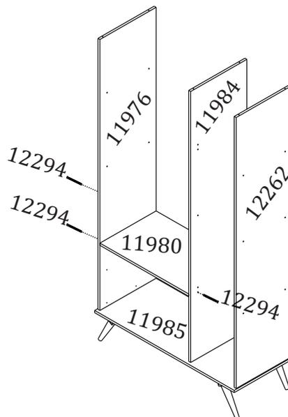
**4** Fixe as prateleiras (11987) na lateral (12262) e na divisão (11984) utilizando o parafuso (12294). Em seguida, fixe a prateleira (11980) na lateral (11976) e na divisão (11984) utilizando o parafuso (12294).
