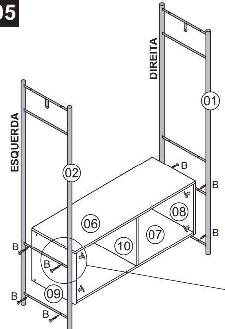
**09** - Parafuse a caixa nas peças (01) e (02), utilizando o CJ. parafuso (B). Não aperte totalmente.
