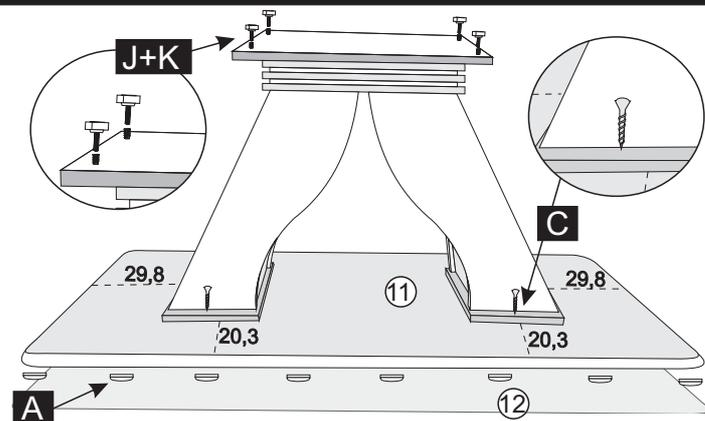
7º FIXAR O TAMPO UTILIZANDO PARAFUSOS 04X25 CONFORME MEDIDAS ABAIXO
