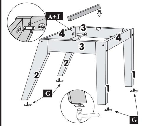
7º - FINALIZAR A MONTAGEM PARAFUSANDO O ASSENTO NO CHASSI DE PÉS UTILIZANDO CANTONEIRAS 2 e 4 FURROS + PARAFUSOS 3,5X10.
