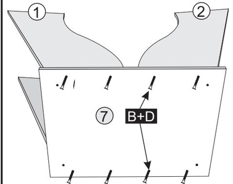
4º- UNIR OS DETALHES MAIOR Nº 06 E MENOR Nº 05 E 04 SAPATA UTILIZANDO PARAFUSOS 1/4X110 E PORCA GARRA
