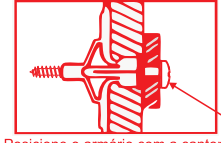
4 - Posicione o armário com a cantoneira sobre a bucha e fixe-o com um parafuso
