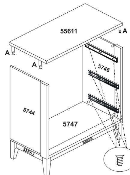
Obs.: Desmontar o trilho telescópico "Q". Para isto, aperte o dispositivo preto do trilho e retire a parte interna do mesmo, a qual será fixada na lateral da gaveta.
