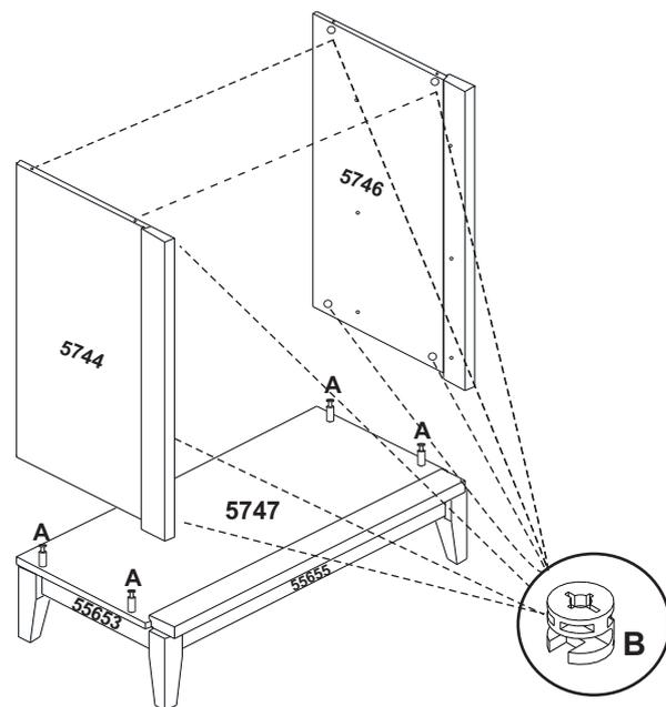
**Passo 3:** 7) Fixar os Parafusos minifix "A" no tampo (55611).
