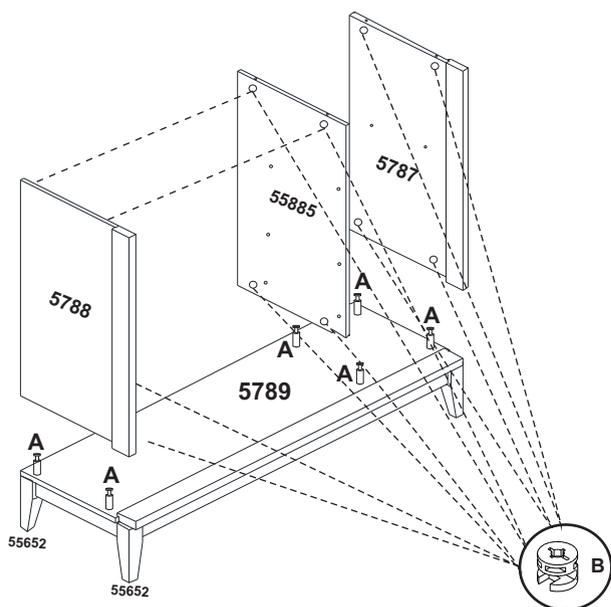
**Passo 3:** 7) Fixar os Parafusos minifix "A" no tampo (55892).
