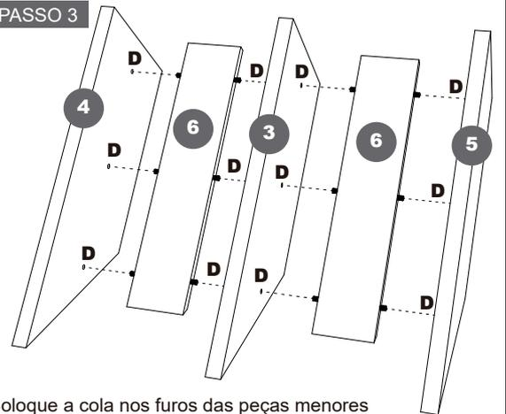
Coloque a cola nos furos das peças menores com furo (3, 4 e 5) e encaixe os detalhes (6) conforme a ilustração acima.
