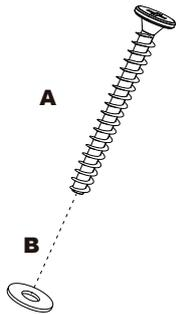
Coloque as arruelas (B) em todos os parafusos 7x60 (A).
