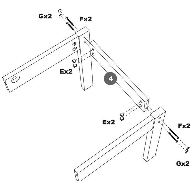
Utilize as porcas cilíndricas (E) com os parafusos 5x50 (F) para fixar os conjuntos montados anteriormente na travessa inferior (4). Depois, cubra os parafusos com os tapa-furos adesivos (G).
