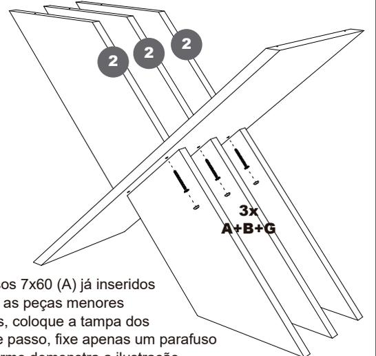
Utilizando os parafusos 7x60 (A) já inseridos nas arruelas (B), fixe as peças menores sem furos (2). Depois, coloque a tampa dos parafusos (G). Nesse passo, fixe apenas um parafuso em cada peça, conforme demonstra a ilustração.
