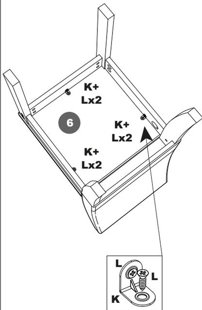
Fixe o assento (6) na estrutura da cadeira utilizando as cantoneiras (K) e os parafusos 3,5x14 (L).
