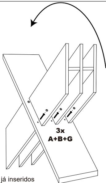
Vire a base, conforme a ilustração para facilitar o acesso aos furos para os outros 3 parafusos 7x60 (A) já inseridos nas arruelas (B). Depois, aplique a tampa (G).
