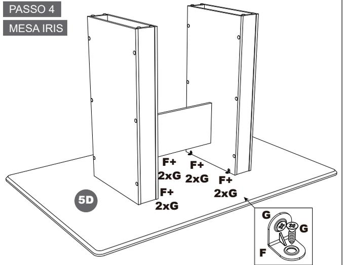
Centralize a base no tampo da mesa e fixe-a utilizando as cantoneiras (F) e os parafusos 3,5x14 (G).
