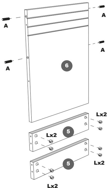
Encaixe as cavilhas (A) e as porcas cilíndricas (L) nos locais indicados.
