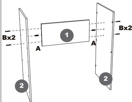
Junte a travessa (1) e as laterais maiores da travessa (2) e fixe-as utilizando os parafusos 5x40 (B).
