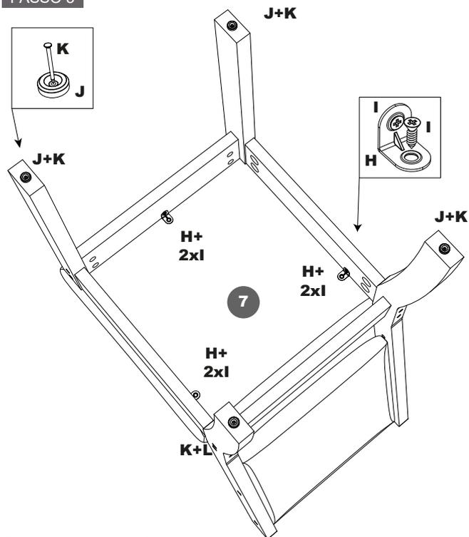
Encaixe o assento (7) na estrutura da cadeira e fixe-o utilizando as cantoneiras (H) e os parafusos 3,5x12 (I). Depois fixe as sapatias (J) nos pés da cadeira utilizando os pregos 8x8 (K).
