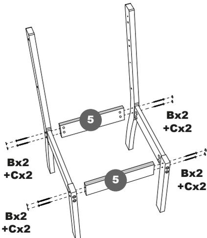
Utilizando os parafusos 5x50 (C), fixe as travessas (5) nos locais indicados. Depois, cole os tapa-furos (C).
