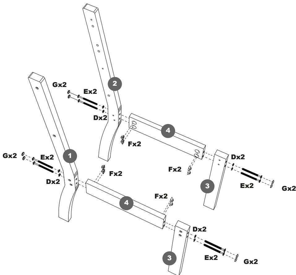
Fixe os pés frontais (3) nas travessas laterais utilizando os parafusos 1/4"x80mm (D) com as arruelas (D) e as porcas elípticas (F). Depois fixe os pés traseiros (1 e 2) utilizando os parafusos 1/4"x80mm (E) com as arruelas (E) e as porcas elípticas (F). Cubra os parafusos com as tampas para parafuso 1/4 (G).
