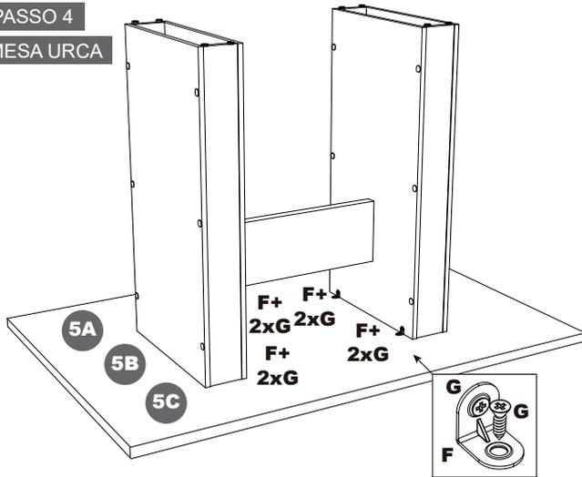
Centralize a base no tampo da mesa e fixe-a utilizando as cantoneiras (F) e os parafusos 3,5x14 (G).
