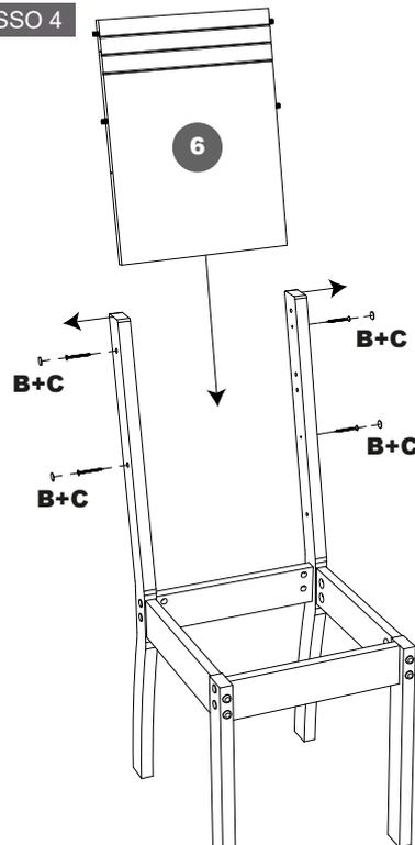
Abra levemente as laterais da cadeira para encaixar o encosto (6). Depois fixe-as utilizando os parafusos 5x50 (B) e cubra-os utilizando os tapa-furos (C).
