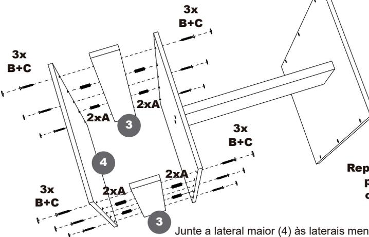
Junte a lateral maior (4) às laterais menores (3) e à lateral maior da travessa (2) utilizando as cavilhas (A) como auxílio. Depois, fixe tudo utilizando os parafusos 5x50 (B) e tampe-s utilizando os tapa-furos (C).
