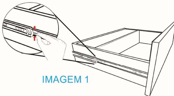
**Retirada da Gaveta:** Primeiro abrir totalmente a gaveta. Ao mesmo tempo, do lado esquerdo, pressione o dispositivo para cima e do lado direito, pressione o dispositivo para baixo. Em seguida, puxe a gaveta.
