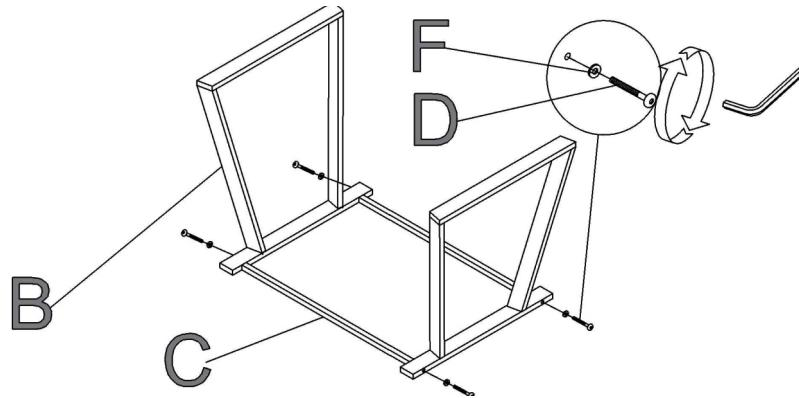
2. Fixe a estrutura da base no tampo A utilizando as arruelas F, os parafusos E e a chave allen.
