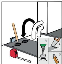
Onde os tubos de aquecimento sobressaem do chão, primeiro corte o painel no comprimento certo, depois coloque-o próximo ao local onde ele irá e use uma régua dobrável para medir e marcar onde as aberturas são necessárias. Também aqui lembre-se de deixar um espaço de 10 mm ao redor deles. Agora você pode usar uma furadeira para remover as áreas marcadas. Aplique cola D3 na peça serrada, coloque-a atrás do tubo de aquecimento e junte-a firmemente à outra peça do painel.
