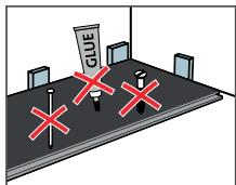
Como a madeira é um material natural, o piso funciona e se move. A instalação flutuante e a folga de expansão de no mínimo 10 mm no perímetro e em outros obstáculos verticais garantem margem de manobra suficiente para flexionar e expandir ligeiramente.
