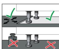
As ilhas de cozinha para cozinhas e outros objetos muito pesados devem ser instaladas primeiro e não colocadas em cima do Piso Grand Selection. O piso deve ser capaz de se movimentar em torno de objetos pesados para evitar juntas abertas e separação de tábuas. O piso destina-se a flutuar no contrapiso. Em outras palavras, não deve ser colado, pregado, fixado de outra forma ou objetos pesados colocados sobre ele.
