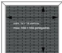
Perfis de juntas de dilatação são necessários em portas, arcos (aberturas sem portas entre salas), alvenaria saliente e salas com formas complexas. Com comprimentos superiores a 14 m e larguras superiores a 14 m, deve haver uma folga de expansão intermediária. O inchaço e o encolhimento são lineares, portanto, quanto maior a superfície, maior deve ser a margem de manobra na borda.
