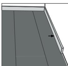
Complete a instalação do piso com o rodapé de sua escolha para cobrir as lacunas de dilatação. Certifique-se de que o rodapé está fixado à parede e não fixa os painéis do piso ao solo. Os perfis de transição devem ser montados entre diferentes revestimentos de piso em salas adjacentes. Dependendo do tipo de perfil, ele deve ser colado, parafusado ou encaixado.
