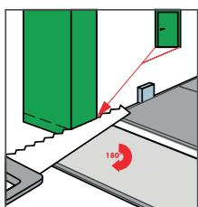
Verifique se as portas ainda podem abrir e fechar após a instalação do piso e da base. Se o batente da porta for instalado após a instalação no piso, certifique-se de deixar uma folga vertical de 1 mm entre a base da moldura da porta e a superfície do piso.
