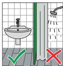
Estas instruções de instalação podem evitar a infiltração de água ao redor do perímetro e obstáculos do seu piso em áreas molhadas. O piso resistente à água não é adequado para uso em espaços úmidos como chuveiros, áreas de piscinas, saunas e salas com ralos embutidos.
