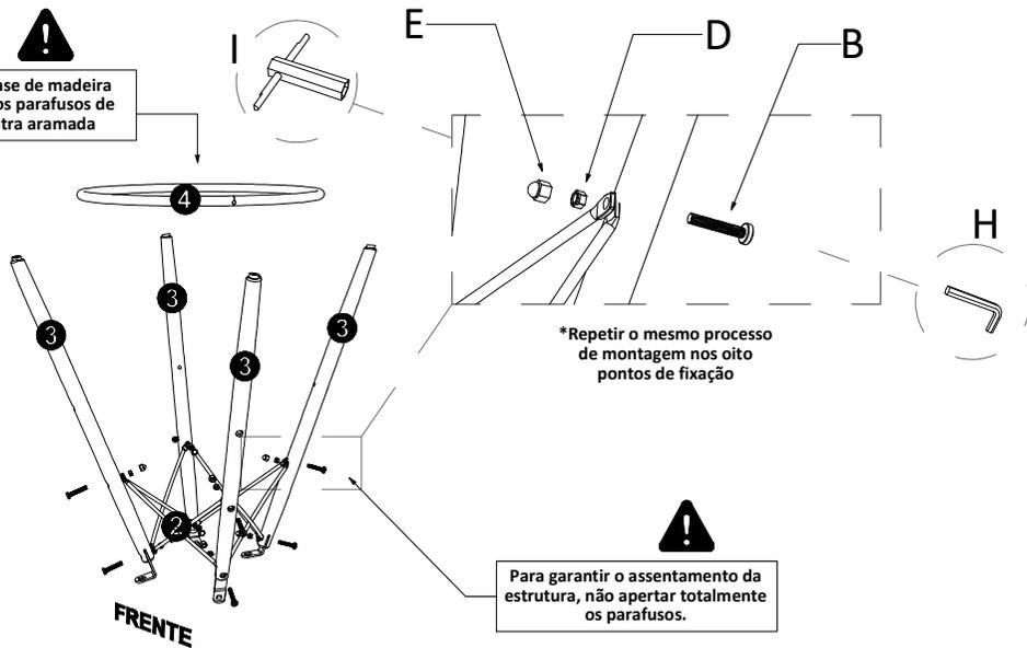
\*Repetir o mesmo processo de montagem nos oito pontos de fixação
