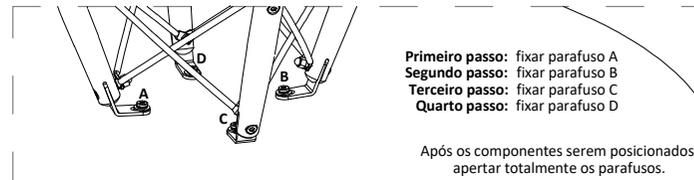
**\*Repetir o mesmo processo de montagem nos quatro pontos de fixação**
