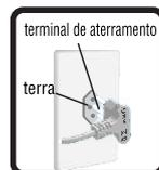
O plugue possui 3 pinos, sendo o central o terminal de aterramento. A tomada de instalação deve ser ligada a um aterramento eficiente, atendendo normas ABNT NBR 5410 e NBR 14136.
