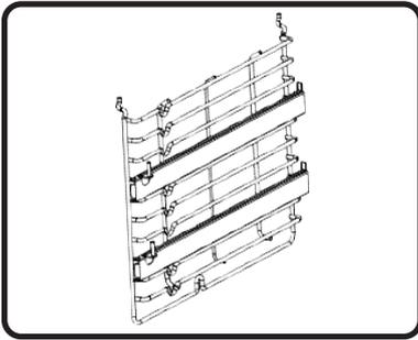
Guias telescópicas: facilita a utilização do forno. As guias e suportes deslizante podem ser desmontados desparafusando os parafusos usados para fixá-las.
