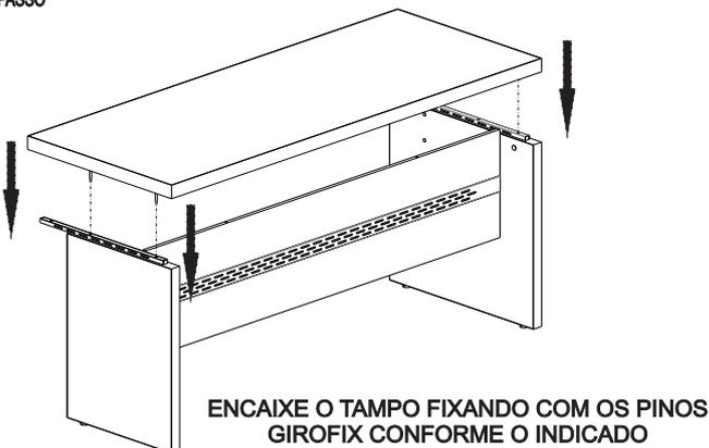
ENCAIXE O TAMPO FIXANDO COM OS PINOS GIROFIX CONFORME O INDICADO
