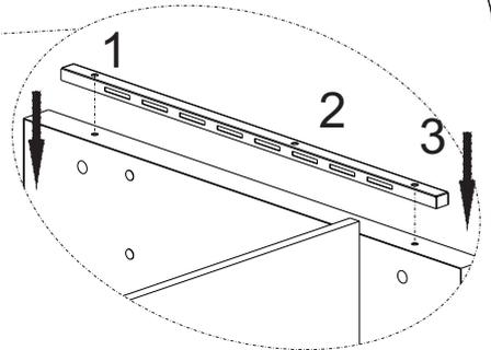
POSICIONE OS DISTANCIADORES NA FURAÇÃO DOS PÉ PAINÉIS CONFORME O INDICADO
