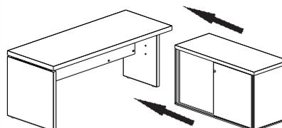
APOIE A MESA EM CIMA DO TAMPO DO ARMÁRIO JÁ MONTADO CONFORME O INDICADO
