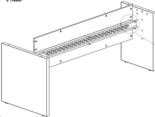
ENCAIXE A RETAGUARDA DE AÇO NO MEIO DAS RETAGUARDAS E FIXE A MESMA POR DENTRO COM O PARAFUSO 4,0 x 14 CAB. CHATA CONFORME O INDICADO
