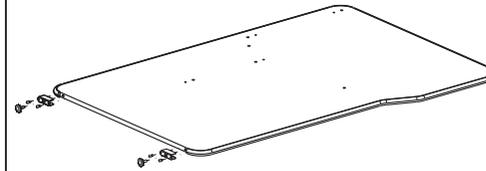
ENCAIXE AS CASTANHAS GIROFIX NAS RETAGUARDAS CONFORME O INDICADO
