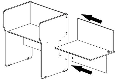
FIXE OS PINOS GIROFIX NA LATERAL DA ESTAÇÃO MONTADA E ENCAIXE AS RETAGUARDAS E ENCAIXE O TAMPO FIXANDO A CANTONEIRA COM O PARAFUSO 4,5 X 16
