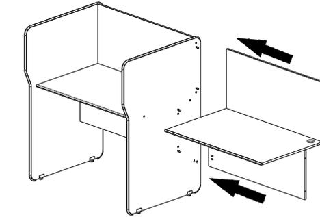
FIXE OS PINOS GIROFIX NA LATERAL DA ESTAÇÃO MONTADA E ENCAIXE AS RETAGUARDAS E ENCAIXE O TAMPO FIXANDO A CANTONEIRA COM O PARAFUSO 4,5 X 16
