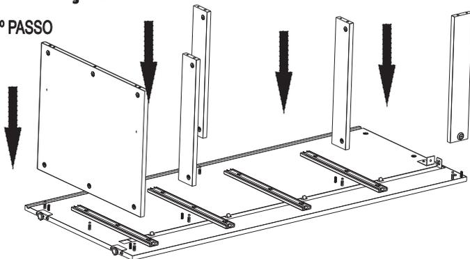
POSICIONE E ENCAIXE OS REFORÇOS CENTRAIS, TRAVESSA FECHADURA E O FUNDO NA LATERAL DIREITA CONFORME O INDICADO
