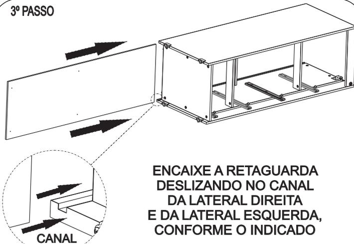
ENCAIXE A RETAGUARDA DESLIZANDO NO CANAL DA LATERAL DIREITA E DA LATERAL ESQUERDA, CONFORME O INDICADO
