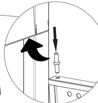
ENCAIXE O PINO ARRUELADO NA PORTA E ENCAIXE A PORTA NO ROUPEIRO GUIANDO PELA FURAÇÃO DAS PRATELEIRAS COM O PINO JA ENCAIXADO NA PORTA CONFORME INDICADO
