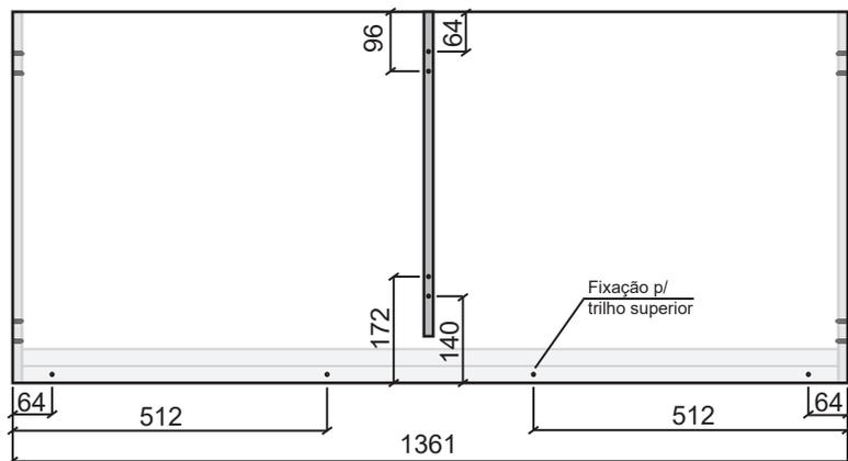
3. Lateral Esquerda\_Furação Interna\_2350X600X15mm
