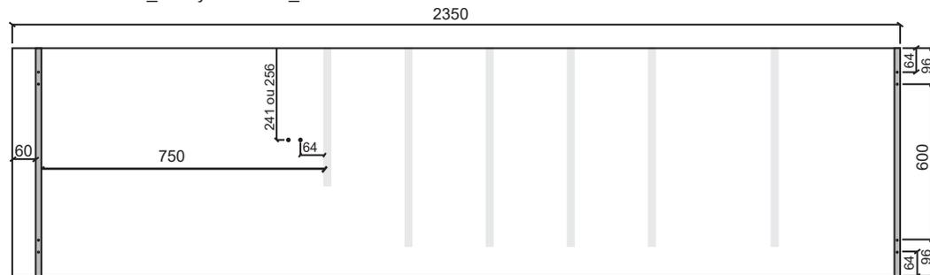
5. Divisória\_Furação Face voltada p/ Lateral Esquerda\_2260X525X15mm
