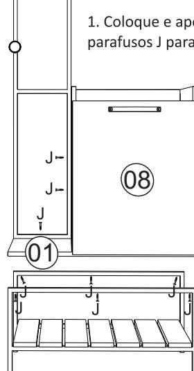
1. Coloque e aperte os parafusos J para fixar.
