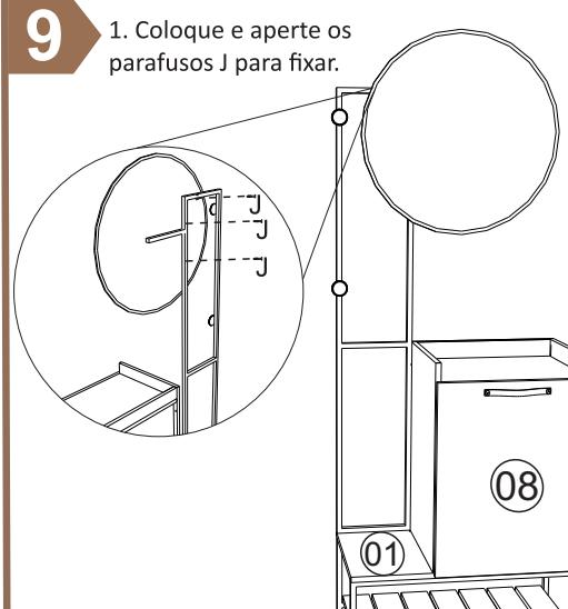
1. Coloque e aperte os parafusos J para fixar.
