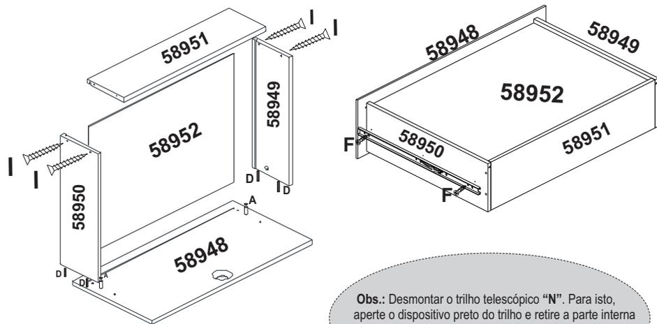
Obs.: Desmontar o trilho telescópico "N". Para isto, aperte o dispositivo preto do trilho e retire a parte interna do mesmo, a qual será fixada na lateral da gaveta.
