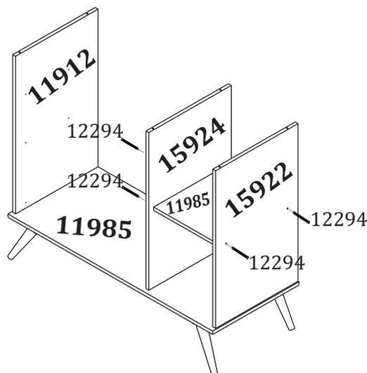
**5** Fixe as cavilhas (2473) nas laterais (11912/15922) e na divisão (15924) e em seguida, encaixe o tampo (17757) fixando com a cantoneira (2466) e o parafuso (2504).
