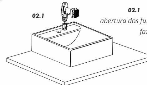
02.1 Neste caso, deve-se proceder com a abertura dos furos, utilizando broca para mármore, fazendo a furação da parte esmaltada para baixo utilizando água.
