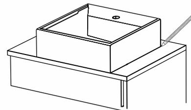
01 Posicione a sua cuba sobre o tampo na posição que se deseja instalá-la, considerando o ideal posicionamento das torneiras e da saída de esgoto. Marque no tampo onde será efetuado o furo para a saída de esgoto e também o contorno da peça, verificando o esquadro com a parede.
