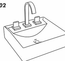
02 Marque o local de passagem dos engates flexíveis para entrada da água quando utilizar misturadores acoplados
