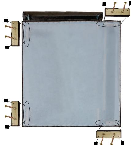
**4** Remova a proteção das catracas, e encaixe as duas hastes nos furos nas laterais do apoio do encosto, forçando para baixo até que enoste na base. Com o encosto totalmente aberto, localize o velcro por baixo do encosto, conduza o tecido costurado na base da almofada até que seja possível a união das peças, conforme bi-foto:
