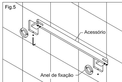
6. Encaixe o **toalheiro** montado nos **anéis** fixos na parede, com o furo lateral do toalheiro voltado para baixo, parafusar com **chave Allen** que é fornecido juntamente com o produto, conforme. (Fig.6)
