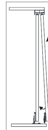
Montando a porta central nos trilhos.
