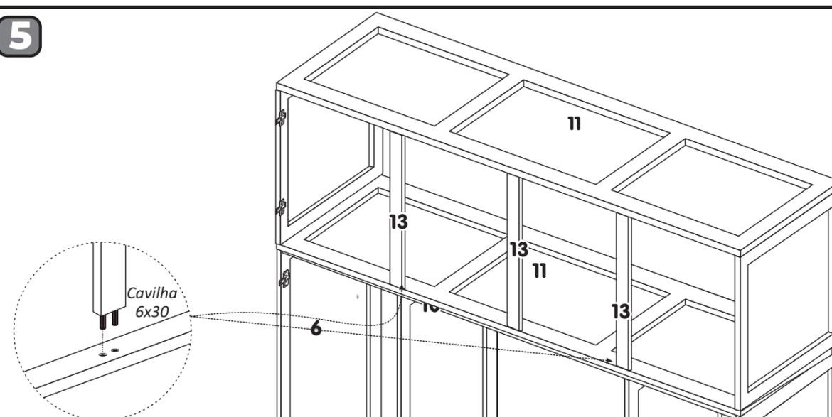
Fixar batentes do maleiro 13 com cavilhas 6x30 e fixar o tampo 11 conforme figura acima.
