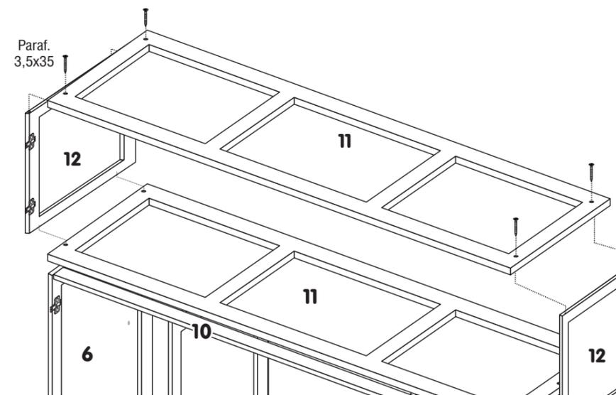
Fixar tampo 11 nas laterais 12 com parafusos 3,5x35 e apoia-lo sobre a trava 10 conforme figura acima.
