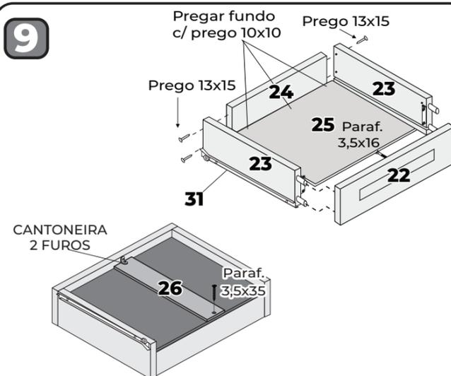
Fixar as laterais das gavetas na frente com cantoneiras 4 furos e cavilha 6x30 depois fixar as costas com prego 10x10, fixar o fundo, colocar o reforço da gaveta (26) c/ paraf. 3,5x35 e cantoneira 2 furos c/ parafuso 3,5x14 e por último colocar a corrediça conforme figura acima.
