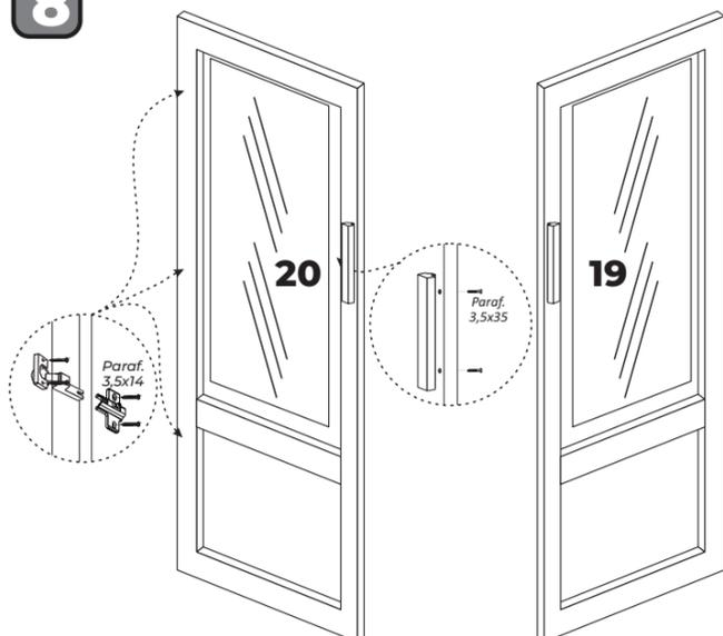
Fixar as dobradiças nas portas grandes e pequenas com parafuso 3,5x14, fixar os puxadores nas portas com parafuso 3,5x35 conforme figura acima.
