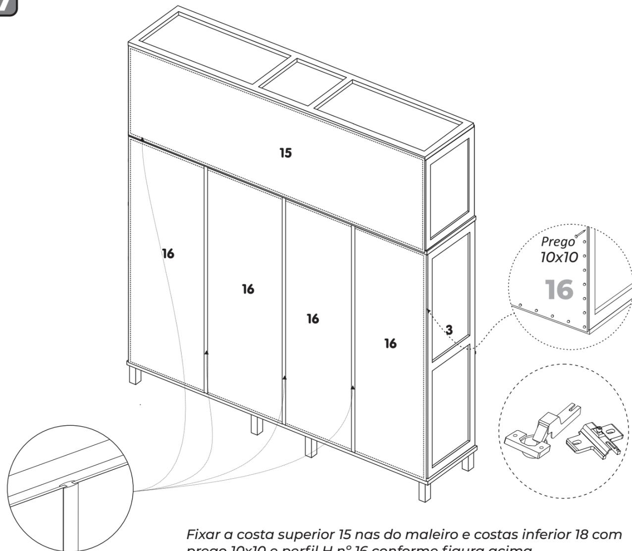
Fixar a costa superior 15 nas do maleiro e costas inferior 18 com prego 10x10 e perfil H n° 16 conforme figura acima.
