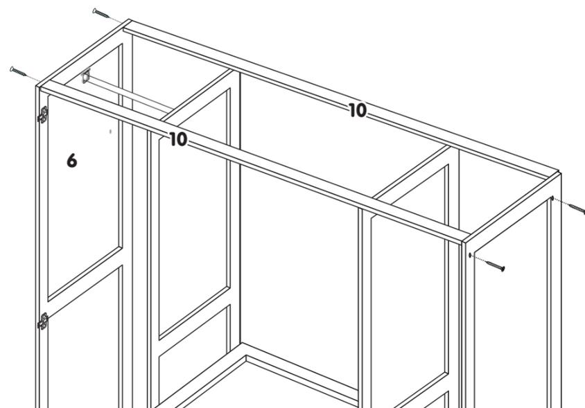
Fixar trava apoio maleiro 10 com parafuso 4,0x45 conforme figura acima
