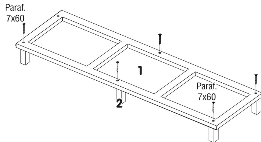
Parafusar pés n° 2 de dentro pra fora utilizando parafuso 6,0x60 na base 1 como mostrado na figura acima.
