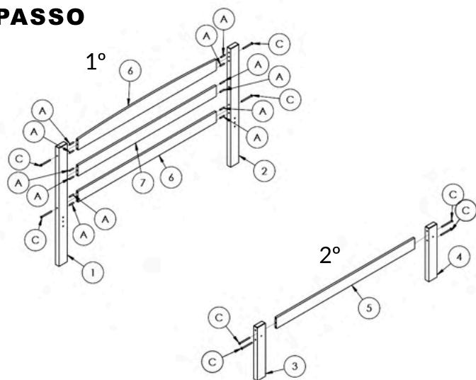
1º Passo: Fixar as Cavilhas (A) nas peças (1) e (2), fixar as peças (1) e (2) nas peças (6), (7) e (8), fixar as peças utilizando os Parafusos (C) com a Chave Zeta (I).
