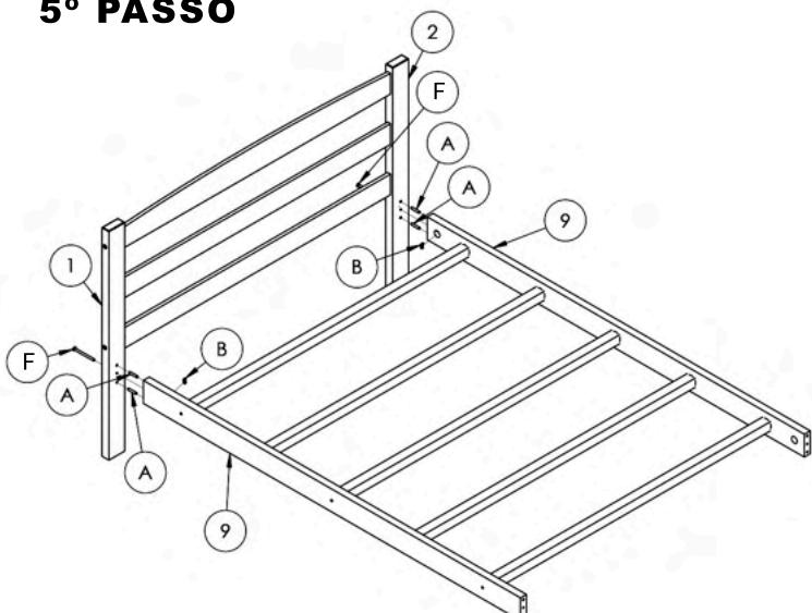
Fixar as Cavilhas (A) nas peças (1) e (2), fixar as peças (1) e (2) nas peças (9), fixar as Porca meia lua (B) nas peças (9), fixar as peças com os Parafusos (F) utilizando uma Chave Zeta (I).
