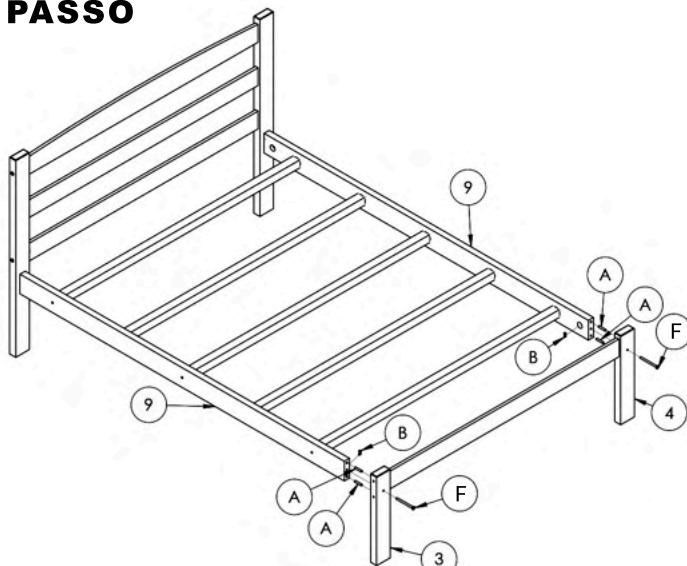
Fixar as cavilhas (A) nas peças (3) e (4), fixar as peças (3) e (4) nas peças (9), fixar as Porca meia lua (B) nas peças (9), fixar as peças com os Parafusos (F) utilizando uma Chave Zeta (I).
