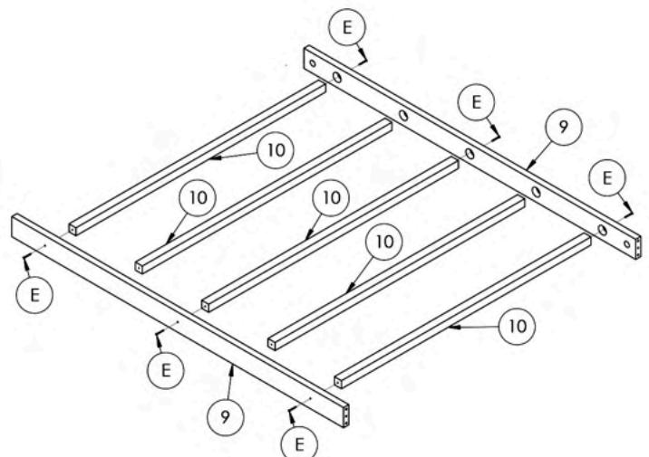
Fixar as peças (10) nas peças (9) utilizando os Parafusos (E) com uma Chave Phillips.
