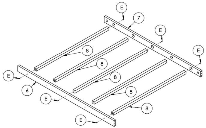
Fixar as peças (8) nas peças (7) utilizando os Parafusos (E) com uma Chave Phillips.
