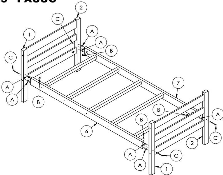
Passar Cola (G) nos furos das Cavilhas nas peças (1) e (2), fixar as Cavilhas (A) nas peças (1) e (2) fixar as peças (1) e (2) nas peças (6) e (7), fixar as Porca meia lua (B) nas peças (6) e (7), fixar as peças utilizando os Parafusos (C) com a Chave Zeta (H).
