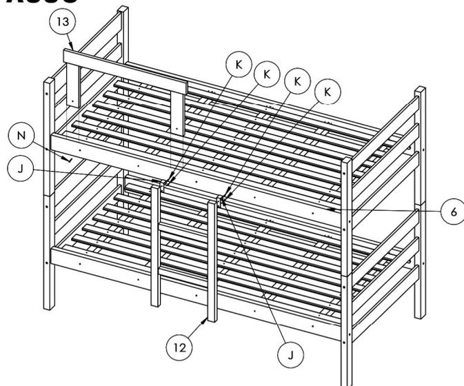
Fixar a peça (13) com os Parafusos (N) na peça (6) com uma Chave Phillips, fixar a peça (12) com o Suporte (J) e os Parafusos (K) na peça (6) utilizando uma Chave Phillips.
