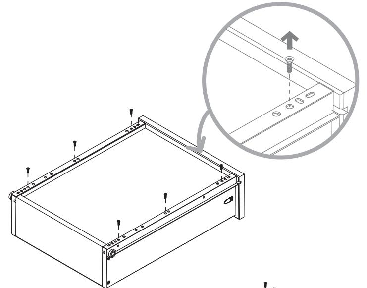
Utilize os furos de regulagem e ajuste a corrediça para a esquerda ou para a direita, conforme sua necessidade.
