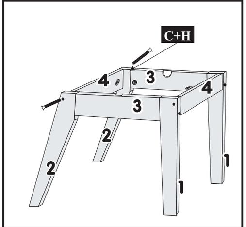
4º - TRAVAR O PÉ TRASEIRO Nº2 COM AS TRAVAS LATERAIS Nº 3 UTILIZANDO CHAPA JUNÇÃO 2 FUROS + PARAFUSOS 3,5X10. DEPOIS FIXAR AS SAPATAS DESLIZADORAS.
