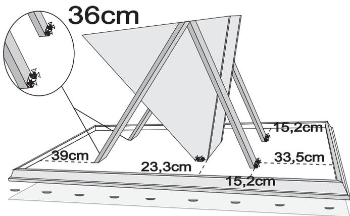
07º- Centralizar a base no tampo 1,80x0,90 COPO Seguindo as medidas: Travar com cantoneiras 4 furos + parafusos3,5x14
