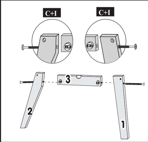
2º - UNIR O CONJUNTO LATERAL COM A TRAVA FRONTAL Nº4 UTILIZANDO ANEL FIXADOR + PARAFUSOS 1/4X70 CAB.13mm
