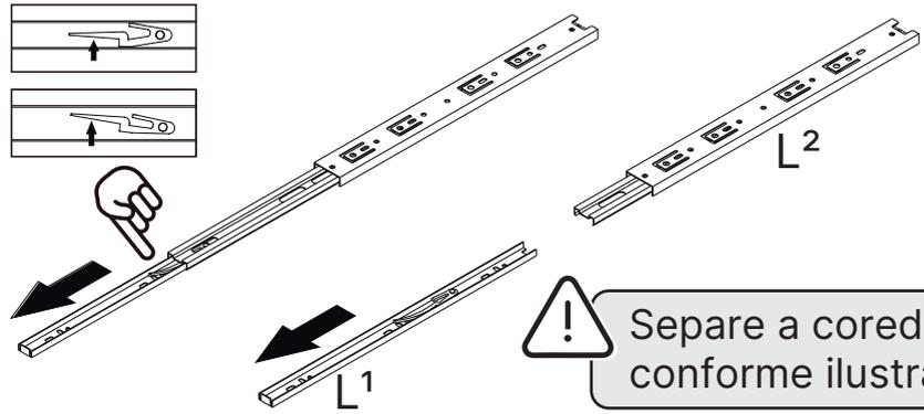
! Separe a coredeça conforme ilustração
