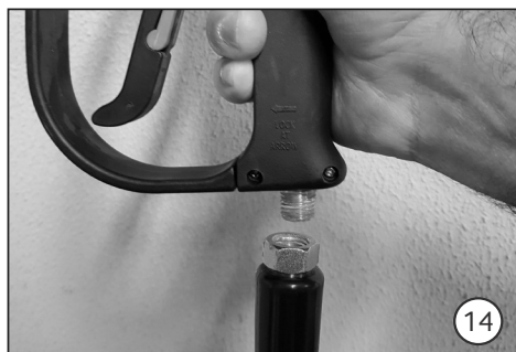
14. Conecte a mangueira de alta pressão na pistola e rosqueie com o auxílio de uma chave de boca.
