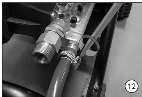
12. Fixar a mangueira de alimentação de água na conexão da bomba com o auxílio de uma abraçadeira ajustável
