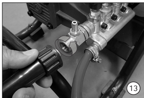
13. Conecte a mangueira de alta pressão na saída de água e gire a manopla até travar.
