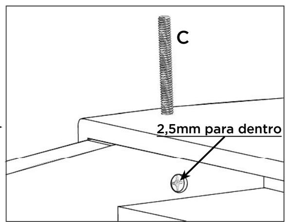
Deixar a Porca Cilíndrica Roscada (D) com a furação voltada para cima, pois esta, irá se encaixar com a Haste Roscada (C).
