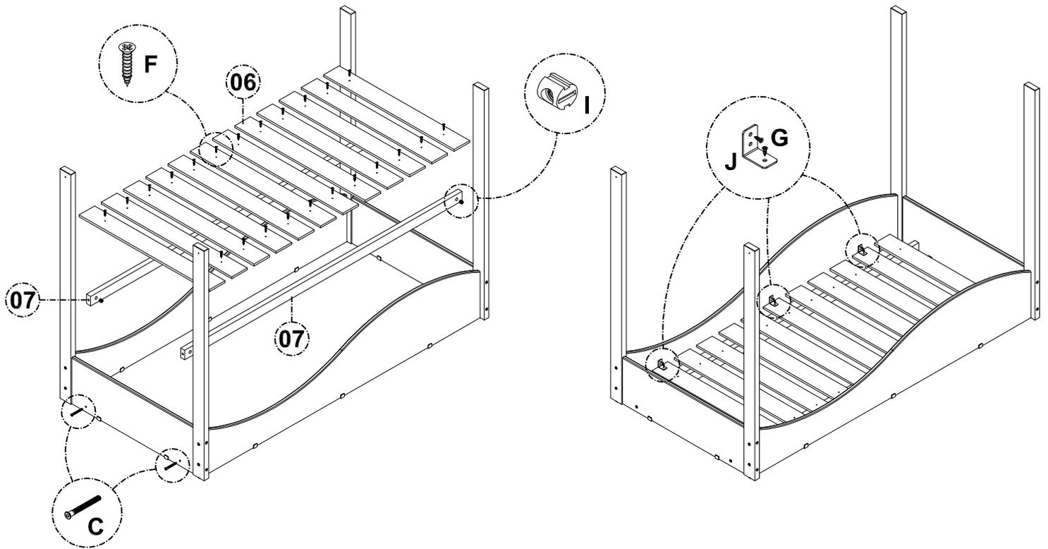
9° - Fixe as molduras nos pés com parafusos CH PHS 5x30 c/ pont.
