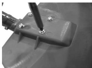
A lâmina limitadora de comprimento do fio de nylon é afiada e pode causar ferimentos, para manuseá-la sempre utilize luvas.
