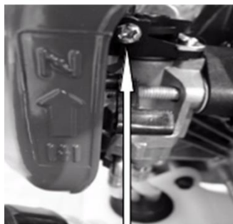
Parafuso de regulagem da lenta
