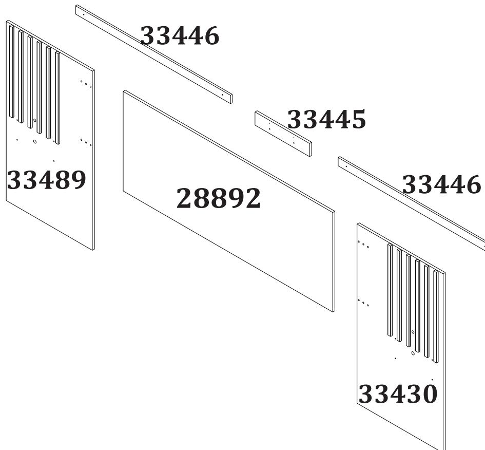
**1** Fixe as sapatas (11063) nos painéis (33430/33489) com os parafusos (2503). Em seguida, fixe o painel central (28892) nos painéis ripados (33430/33489) utilizando os parafusos (2567).
