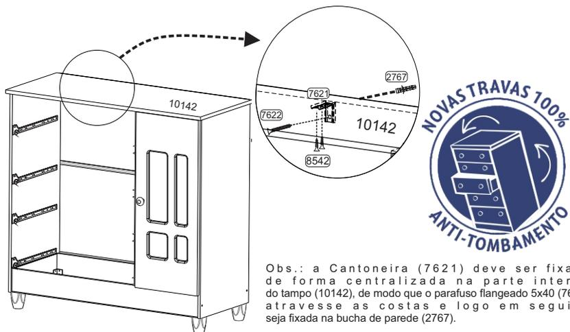
Obs.: a Cantoneira (7621) deve ser fixada de forma centralizada na parte interna do tampo (10142), de modo que o parafuso flangeado 5x40 (7622) atravesse as costas e logo em seguida seja fixada na bucha de parede (2767).
