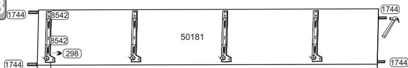
Obs.: Os parafusos 3,5x10 devem ser fixados no 1º furo e no 7º furo, conforme a ilustração ao lado.
