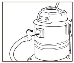
MANGUEIRA DE SUCÇÃO: Conecte a mangueira de sucção no bocal do recipiente posicionando as travas (conforme a figura) e, em seguida, gire no sentido horário até travar.
