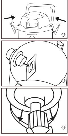
14. LIMPEZA E SUBSTITUIÇÃO DOS FILTROS: Certifique-se que o equipamento esteja desconectado da rede elétrica, solte os dois fechos e retire o cabeçote. Retire o saco de pó quando estiver cheio. Em seguida, retire o filtro HEPA. Lave-o em água corrente e deixe secar. Se aparentar estar saturado, substitua-o.
