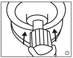
PARA ASPIRAÇÃO DE SÓLIDOS E LÍQUIDOS: Encaixe o filtro HEPA conforme ilustração até fixar.
