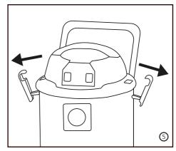
COLOCANDO OS FILTROS NO ASPIRADOR: Solte os dois fechos do cabeçote para acessar os filtros (conforme figuras) e monte os filtros.
