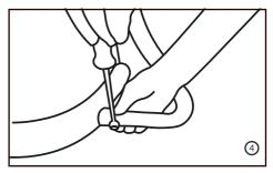
MANGUEIRA DE DRENAGEM: Insira a mangueira de drenagem no bocal inferior do recipiente, posicione corretamente a mangueira com a abraçadeira e aperte com o auxílio de uma chave.
