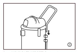
ALÇA PARA TRANSPORTE: Encaixe a alça no recipiente conforme a figura e parafuse a alça nos suportes do recipiente.
