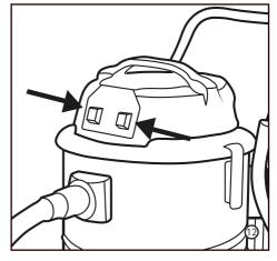
12. INTERRUPTORES LIGAR / DESLIGAR: Pressione o interruptor para ligar ou desligar os motores do aspirador. Esse produto possui dois motores de acionamento individual. Se precisar de potência máxima, ligue os dois motores simultaneamente.
